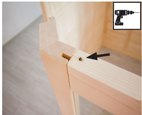
Bohrer 3 mm, 1 Stk. Schrauben 4 x 70 mm
