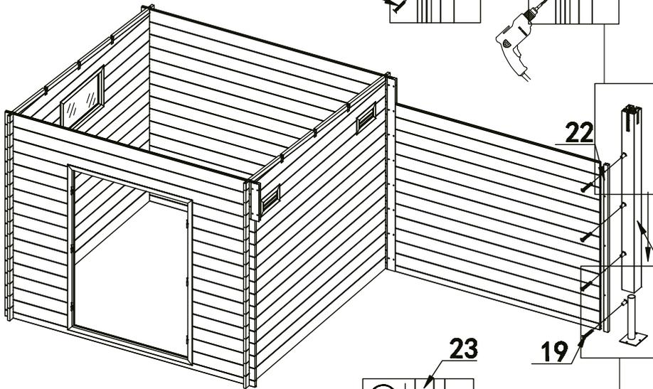
Verbinden Sie den Pfosten 23 mit dem Befestigungsschuh 24 gem. Zeichnung
