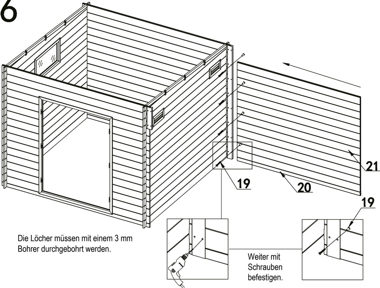
Die Löcher müssen mit einem 3 mm Bohrer durchgebohrt werden.
