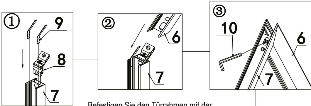
Befestigen Sie den Türrahmen mit der Türverbindung und dem Sechskantschlüssel
