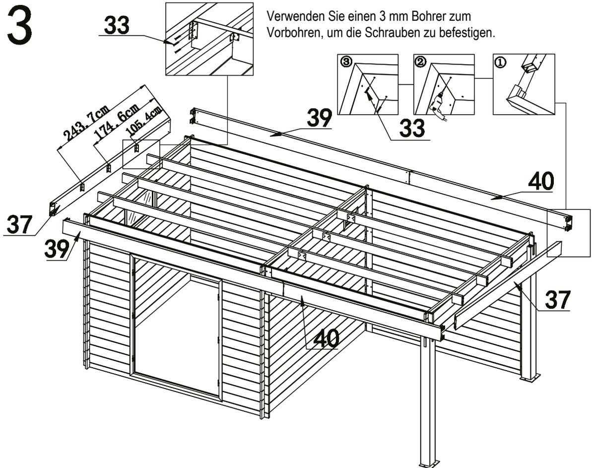
Verwenden Sie einen 3 mm Bohrer zum Vorbohren, um die Schrauben zu befestigen.
