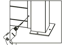
Die Löcher müssen mit einem 3 mm Bohrer durchgebohrt werden.
